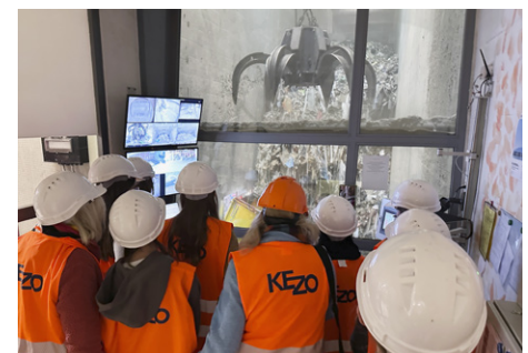
Der Kranführer bedient die riesigen Greifarme, die den haushohen Müll aufschichten und durchmischen, um eine gleichmässige Verbrennung zu bewirken.
